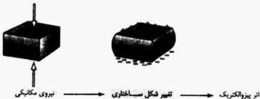
شکل ۲-۳ - اثر پیزوالکتریک تولید میدان الکتریکی در اثر اعمال نیرو بر
