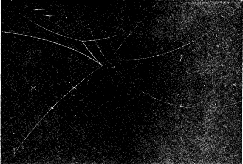
شکل ۵.۲: یک پروتون و یک پادپروتون در انرژی زیاد به یکدیگر برخورد می‌کنند و تعدادی کوآرک تقریباً آزاد تولید می‌نمایند.
